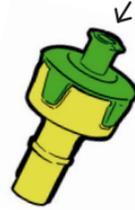
Nutzen Sie den integrierten Luer-Lock-Anschluss optional zum Anschluss von Trockenröhrchen oder zur Begasung mit Schutzgasen.
